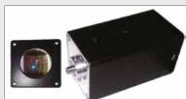
Prototype de spectroimageur ultra miniaturisé rendu possible par l'intégration des fonctions optiques spectro imageantes directement à la surface du détecteur. L'innovation vient de la conception et du développement conjointe du détecteur et des structures miniaturisées comme pour les appareils photos de téléphones portables. Un FUI de spectroimagerie miniaturisée en infrarouge est à l'étude.
