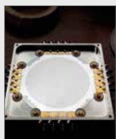
Matrices de NIKA2 : 100 mm de diamètre, 1932 détecteurs observant à une longueur d'onde de 1,2 mm.
