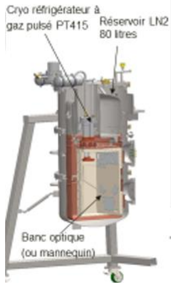
Banc optique 6061 T6 avec ses écrans
